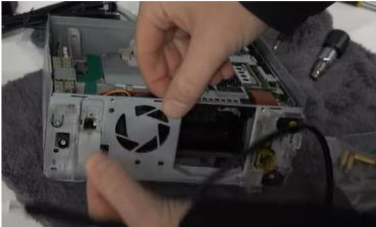
Retirez le support à côté de l'évent pour faire de la place pour le passage des deux câbles qui sont enclenchés sur la carte de circuit imprimé. Positionnez également l'antenne.
